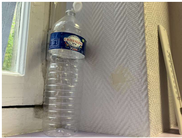
Prélèvement - P73 : Patio 1 / RdC / Façade Ouest / Local 13/15 - Enduit- (Absence d'amiante)
