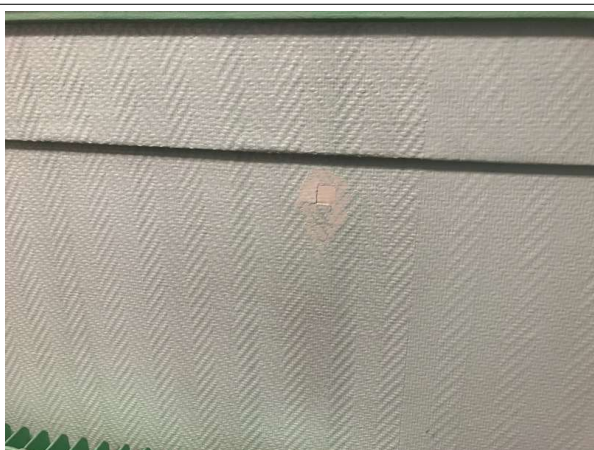
Prélèvement - P65 : Patio 1 / RdC / Façade Ouest / Local 11 - Enduit- (Absence d'amiante)
