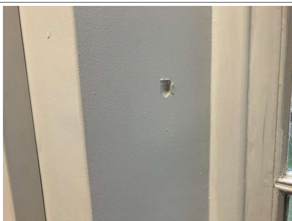
Prélèvement - P3 : Patio 1 / RdC / Façade Est / Local 48 - Enduit- (Absence d'amiante)
